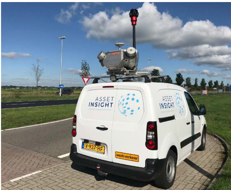
3D-scanauto's worden gebruikt om wegen, dijken en hun omgeving in kaart te brengen.
